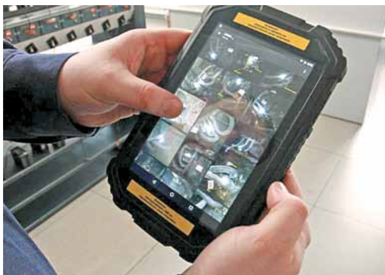
Подземный планшетный компьютер на шахте «Распадская-Коксовая»
