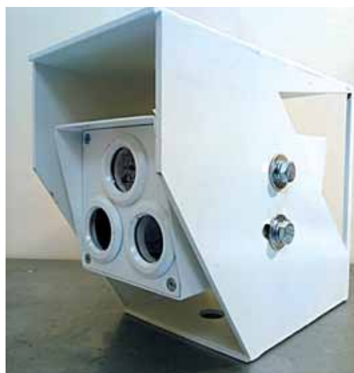
Устройство технического зрения с инфракрасной подсветкой, видеокамерой и тепловизором
